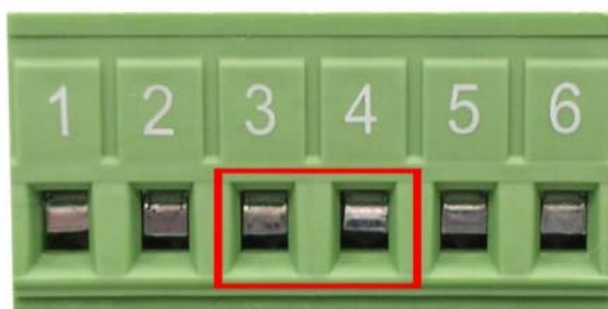
Рисунок-8: Контакты выхода «Неисправность»
